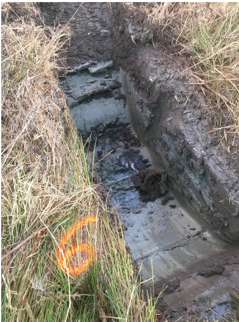
Figur 8. Foto från provgroppsgrävning 2018-01-09 visar typisk jordlagerföljd inom delområde A, lerig mulljord ovan lera i Pg 1806.
