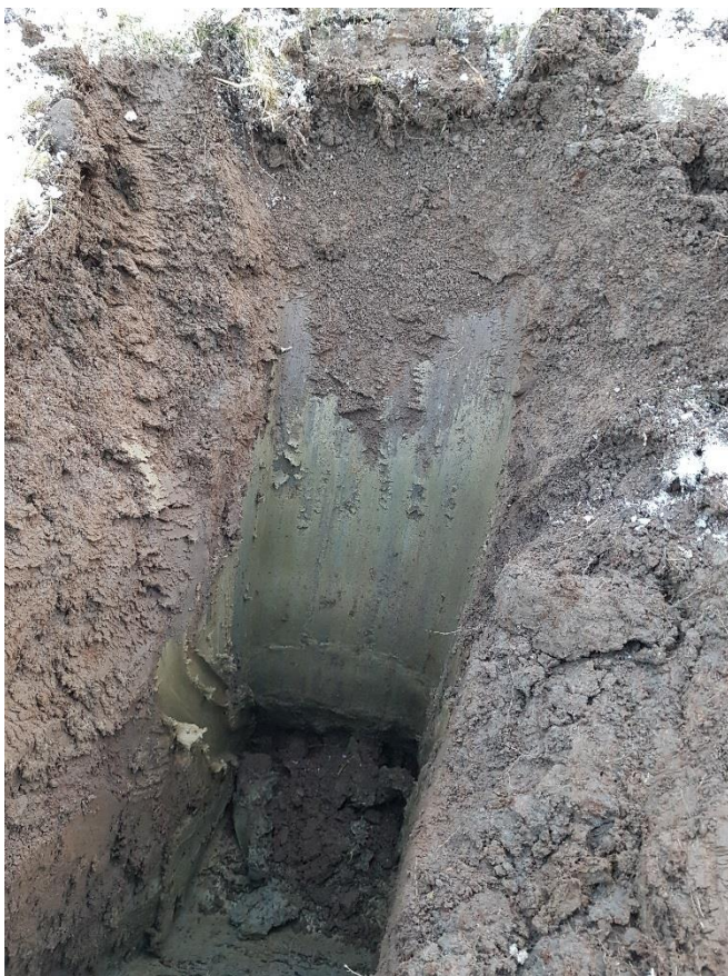
Figur 10. Foto från Pg 1810 visar typisk jordlagerföljd inom delområde C, mulljord ovan lera, 2018-01-22.
